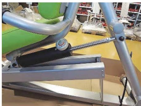
Ein Hydraulikzylinder mit zwei Rückschlagventilen sorgt für einstellbare Widerstände in beide Bewegungsrichtungen.
