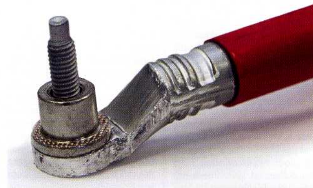
Mit torsionaler Telsonic-Technologie verschweißter Anschlussbolzen auf Leoni-Busbar aus Aluminium
