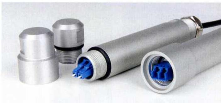
**Verbindungsmodul.** Das Glasfaser-Verbindungsmodul TOCFEM verbindet konfektionierte Glasfaserleitungen im Innenwie im Außenbereich auch unter rauen Bedingungen. Das robuste Metallgehäuse aus eloxiertem Aluminium schützt die Verbindung sicher und zuverlässig vor Umwelteinflüssen und mechanischen Belastungen. Durch einen elastischen Dichteinsatz eignet es sich sowohl für Neuinstallationen als auch für Nachrüstungen vor
