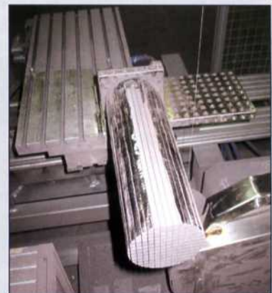
Mit der neuen HK Diamantdrahtsäge lassen sich Siliziumblöcke schnell und sicher trennen
