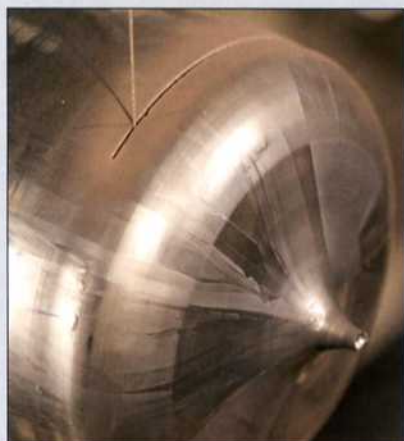
Ein über Umlenkrollen geführter dünner Endlosdraht sägt mit sehr hoher Geschwindigkeit härteste abrasive Werkstoffe
