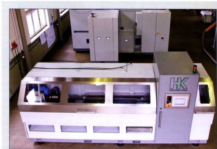
Die neue Diamantdrahtsäge der HK Präzisionstechnik GmbH arbeitet ohne Kühlmittel im Trockenverfahren
