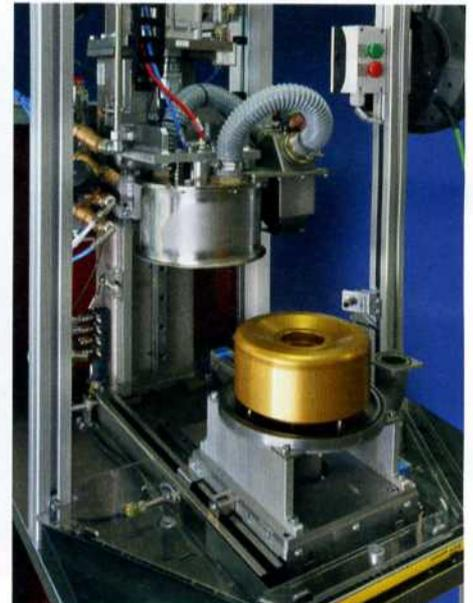
*In wenigen Sekunden liefert der Prüfvorgang zuverlässige Aussagen über die Dichtheit des Werkstücks.*
