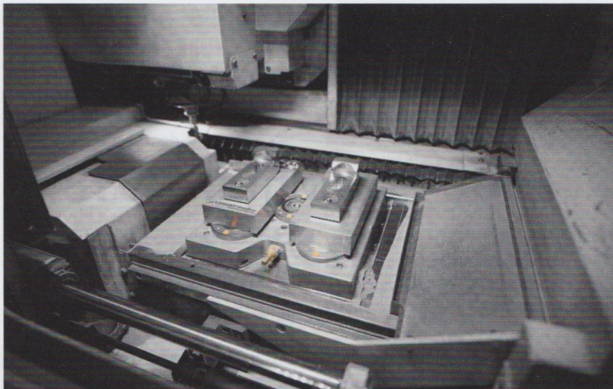
Bild 1: Mit dem Nullpunktspannsystem Zero-Point von AMF lassen sich Rüstzeiten um bis zu 90 Prozent reduzieren
