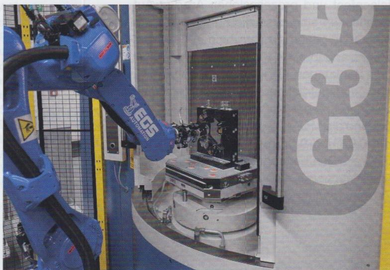
Der Deckel wird senkrecht in die bogenförmige AMF-Vorrichtung eingebracht, die ihn an den schmalen Seiten komplett umschließt
