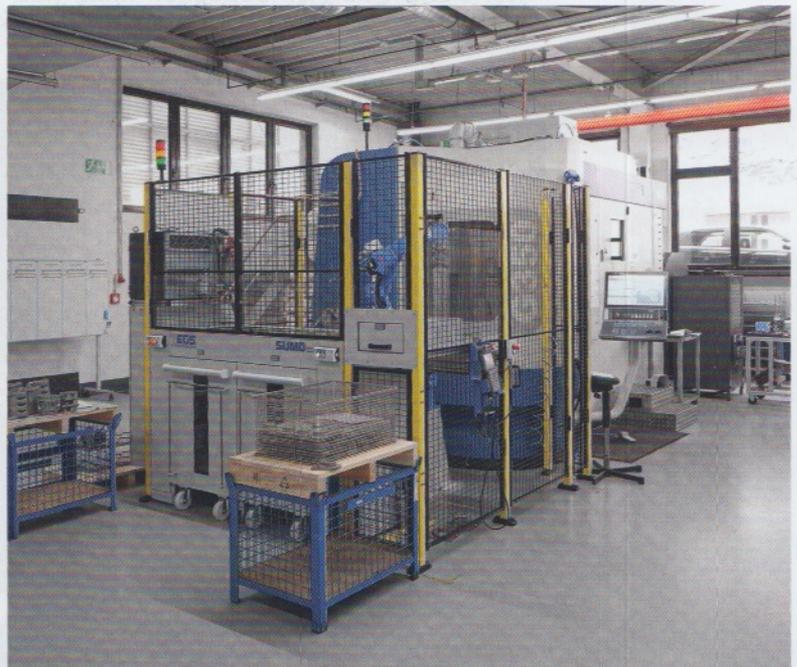
Die vorausschauend automatisierte Fertigung bei Scherzinger macht steigende Abrufzahlen locker mit. Das neue 5-Achs-Bearbeitungszentrum von Grob ist mit einer Automation von EGS und Vorrichtungen von AMF ergänzt (Bilder: AMF)
