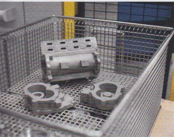
Gehäuse und zwei Deckel aus Aluminiumguss werden bei Scherzinger vollautomatisch und mit AMF-Vorrichtungen mannlos bearbeitet
