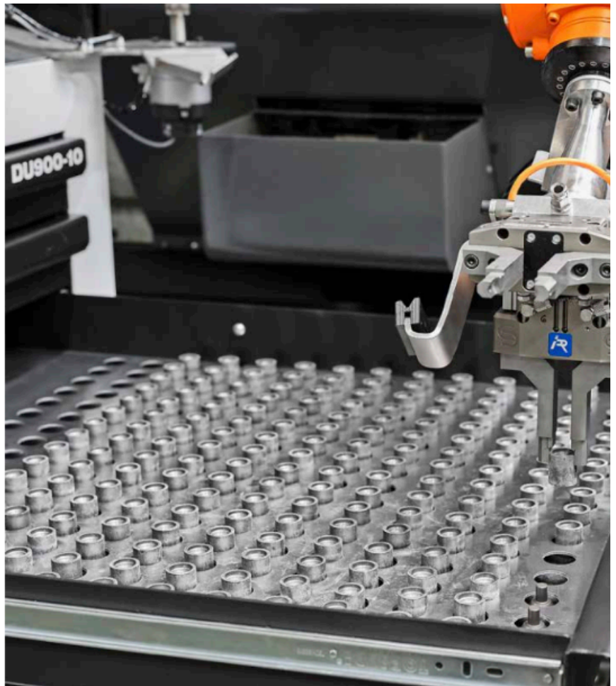
In den Werkstückwagen lassen sich gleichermaßen bis zu 2.000 Roh- und Fertigteile bevorraten.
