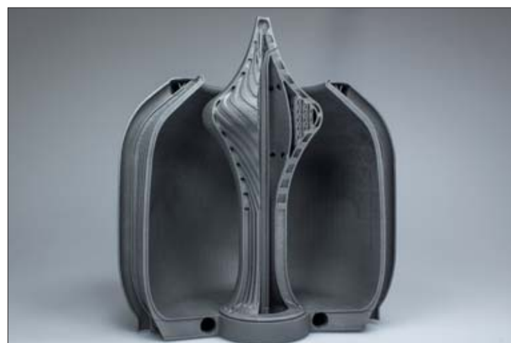
Additiv gefertigtes Raketentriebwerk mit Aerospike (Luftstacheldüse statt herkömmlicher glockenförmiger Düse)
