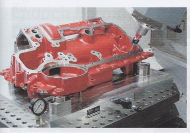
Hydraulische Spannelemente von AMF drücken und ziehen mit exakt dosierten und festgelegten Kräften immer gleich und in der richtigen Reihenfolge an definierten Punkten und handhaben und fixieren Werkstücke prozesssicher
