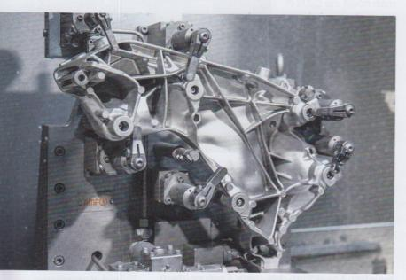
Breit aufgestellte Anbieter wie AMF führen neben Hydraulik-Aggregaten Druck- und Zugzylinder, Schwenk-, Hebel-, Vertikal-, Zentrier- und Kniehebelspanner sowie Ventile, Druckschalter und Drehdurchführungen im Sortiment
