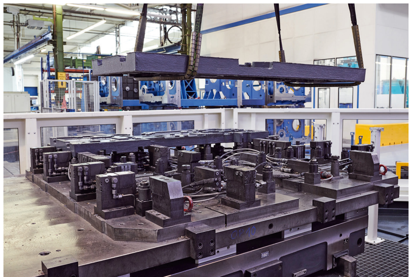
6 AMF beherrscht die Königsdisziplin der Spanntechnik und entwickelt flexible Spannlösungen, auch eingebettet in Vorrichtungen, die für unterschiedliche Bauteilvarianten und kleine Stückzahlen einsetzbar sind © AMF
