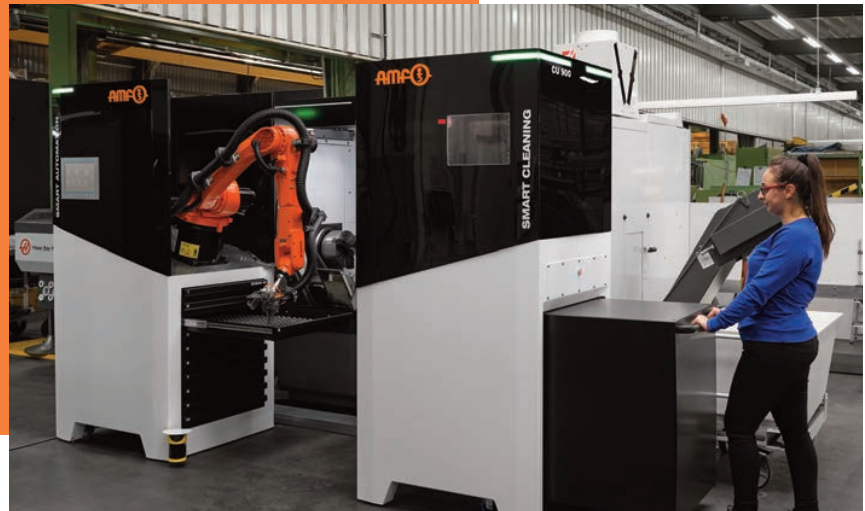
Problemloses Einschieben: Da der Werkstückwagen auf Schwerlastrollen steht, lässt er sich bequem ein- und ausfahren. So gelingt die Bestückung der Schubladen extern und hauptzeitparallel.
