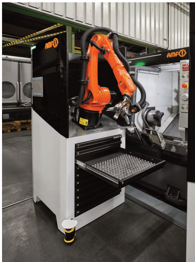
Smart Automation: Die ‚intelligente‘ schlanke Beladezelle von AMF mit sehr wenig Platzbedarf wird an Maschinen beige stellt und schafft mehr Produktivität bis hin zu einer mannlosen Schicht.
