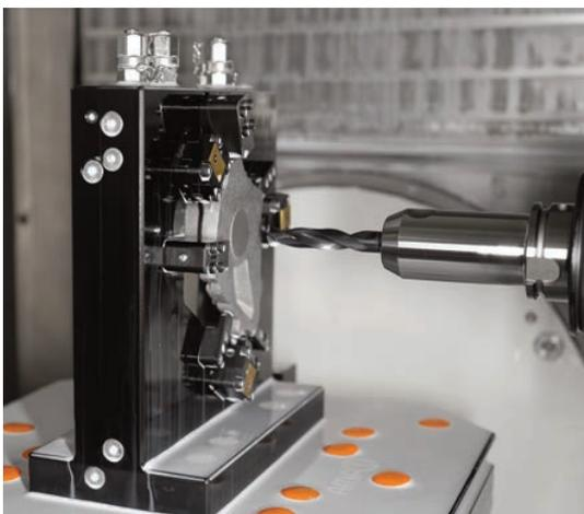
Die Grob 350 kann mit ihrem einzigartigen Maschinenkonzept der horizontalen Spindellage und dem Schwenktisch das Werkstück nach Messung der Lage für jede notwendige Bearbeitung toleranzgenau positionieren.
