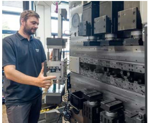
Wenn der Werker das Werkzeug einsteckt, werden die Spannbolzen jeweils mit 1,5 kN eingezogen und mit 13 kN festgehalten.
