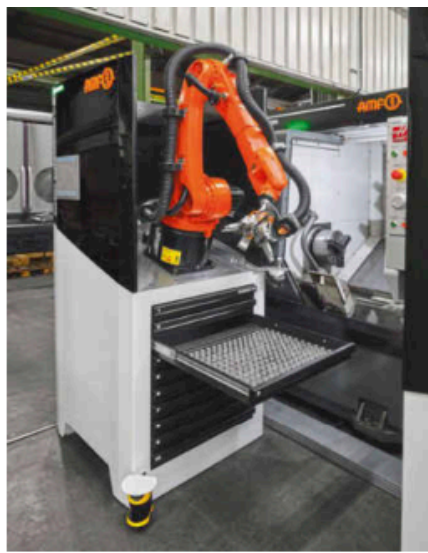
Smart Automation ist eine smarte und schlanke Beladeselle von AMF mit sehr wenig Platzbedarf. Sie wird an Maschinen beigestellt und schafft mehr Produktivität bis hin zu einer mannlosen Schicht. Bild: AMF
