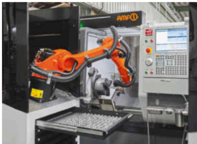
Das neue, flexible Roboter-Beladesystem Smart Automation von AMF automatisiert bei Güthle das Werkstückhandling von Kugelpfannen an der Haas-Drehmaschine. Bild: AMF
