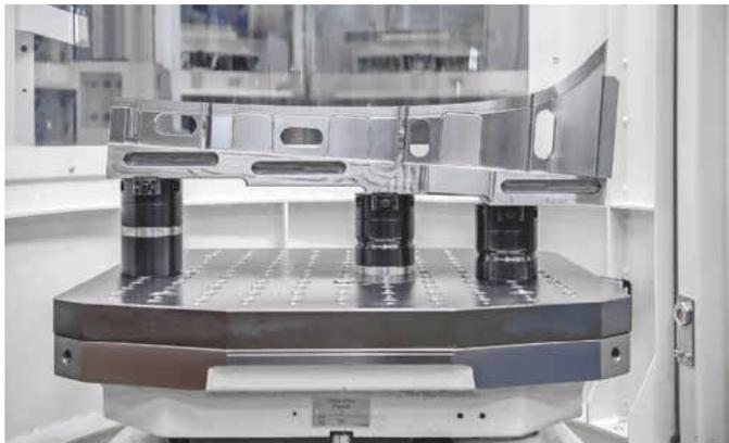
Ein 5-Achs-Bearbeitungs-zentrum von Grob ist bei Koller mit einem Palettenrundspeichersystem mit 13 Paletten ausgerüstet. Durch das modulare Nullpunktspannsystem können die Werkstücke mit komplexer Außenkontur in unterschiedlichen Spannhöhen direkt auf der Palette gespannt werden. Bild: AMF
