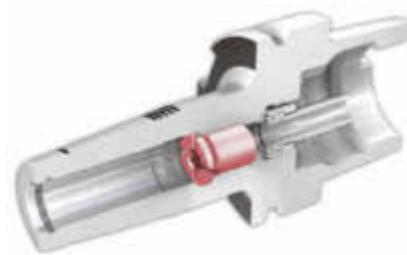
Die Voreinstellschraube CX macht die Jet-Kühlung entlang des Werkzeugschafts erst möglich. Sie darf nicht entfernt werden. Bild: Iscar
