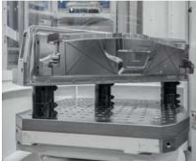
In Verbindung mit einer möglichst automatisierten 5-Seiten-Bearbeitung müssen bei Koller in Dietfurt große Herausforderungen bei der Werkstückspannung gemeistert werden. Seit 2015 gelingt dies mit Hilfe von Nullpunktspanntechnik der Andreas Maier GmbH & Co. KG aus Fellbach.
