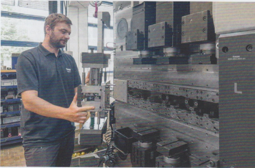
Bild 2 > Wenn der Werker das Werkzeug einsteckt, werden die Spannbolzen jeweils mit 1,5 kN eingezogen und mit 13 kN festgehalten (© Andreas Maier GmbH & Co. KG)
