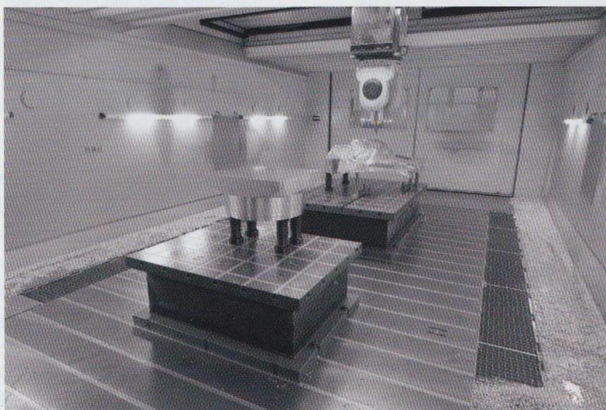
Nullpunktspanntechnik wie von AMF ist ein Gewinn für jede Fertigungs- und Montageumgebung. Die drastische Reduzierung der Rüstzeiten kommt direkt der Produktivität zugute.
