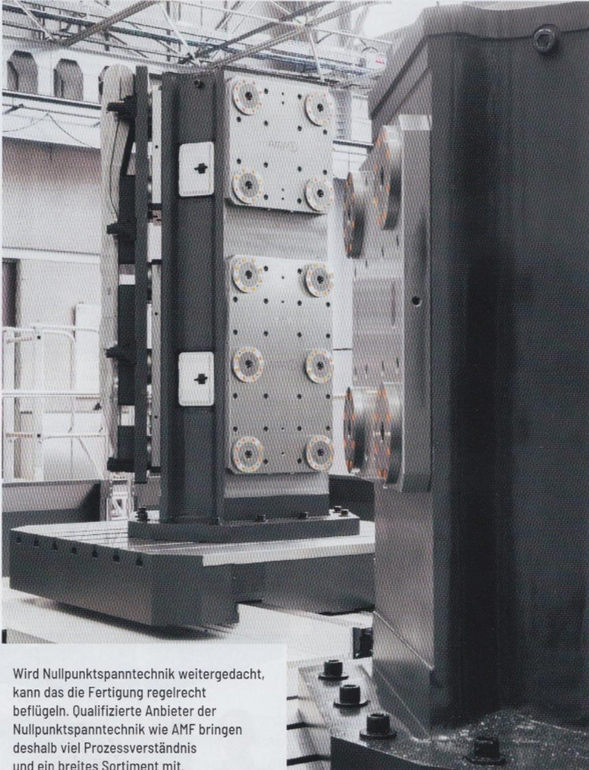
Wird Nullpunktspanntechnik weitergedacht, kann das die Fertigung regelrecht beflügeln. Qualifizierte Anbieter der Nullpunktspanntechnik wie AMF bringen deshalb viel Prozessverständnis und ein breites Sortiment mit.
