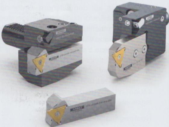
Die Werkzeugplatten lassen sich im ATS Trägersystem mit versenkbarer Schraube befestigen. Damit gelingen Stechprozesse entlang von Schultern, ohne dass die radiale Planfläche angegriffen wird (Bilder: © ARNO)
