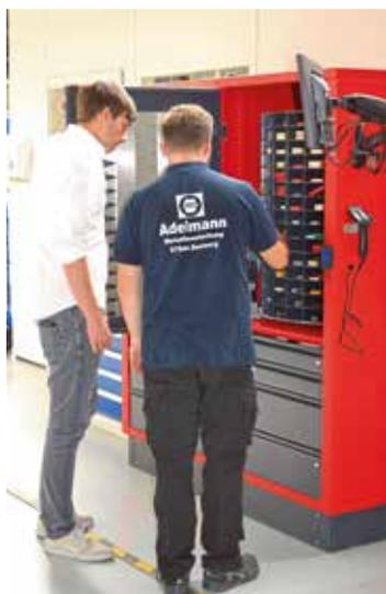
Der neue Store Manager Duo von Arno Werkzeuge verbindet ein Karussellsystem für kleine Teile mit einem Schubladensystem für größere Artikel, wie zum Beispiel Prüfmittel.
