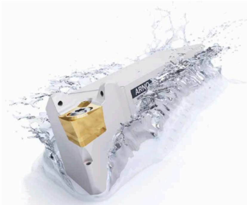
Arno Werkzeuge denkt an seine Kunden: Drei präzise ausgerichtete Kanäle leiten das Kühlmittel von oben und von unten genau an die Schneide, ohne den Spanabfluss zu behindern. Durch die besondere Geometrie des Kühlkanals entsteht ein Düsen-Effekt mit stark verbesserter Kühlwirkung.
