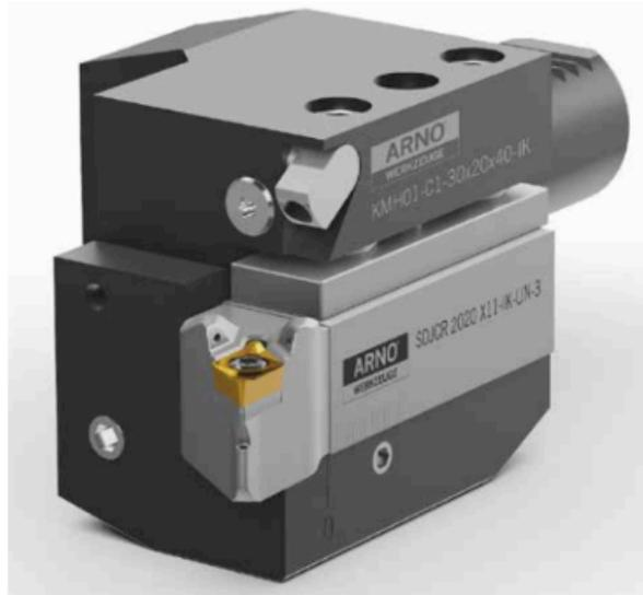
Die von Arno Werkzeuge hybrid hergestellten Klemmhalter mit Innenkanälen für die Kühlflüssigkeit erhöhen die Prozesssicherheit und verbessern durch zielgerichtete Kühlung die Oberflächengüte in Zerspanungsprozessen.
