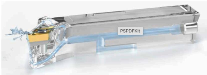
Weil der Kopf des Klemmhalters im 3D-Verfahren aufgesintert wird, entstehen Kanäle, die Kühlflüssigkeit höchst effizient bis zum Schneidwerkzeug führen und die Schneide von oben und von unten kühlen.
