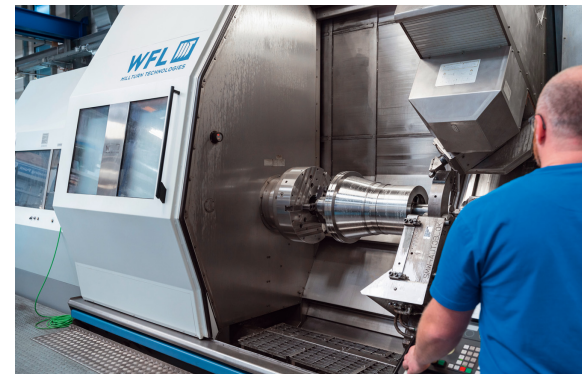
1 Drei WFL-Millturn-Maschinen unterschiedlicher Größe befördern bei Hiller die Strategie der Inhouse-Fertigung von Zentrifugen-Komponenten. Auf der 'mittelgroßen' M80 Millturn ist hier ein Trommelkörper in der Bearbeitung. In der Dekantertrommel wird durch schnelle Rotation erreicht, dass sich Feststoffe an der Trommelinnenwand absetzen © WFL
