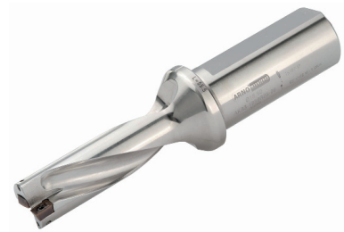
Der ARNO Kurzlochbohrer AKB überzeugt mit 14-55 mm Durchmesser für Bohrungen bis 5 x D mit großem und optimiertem Auslauf der Spankammer bis zum Bund.
