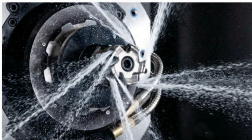
Auf einem 5-Achs-Universal-Bearbeitungszentrum G350 von GROB finden täglich mehrere Live-Demos statt. Neben dem ProACT-Mill wird unter anderem auch das additiv gefertigte Wendeplattenfrässystem MaxiMill – 211-DC mit optimaler Kühlmittelzufuhr im Einsatz gezeigt.
