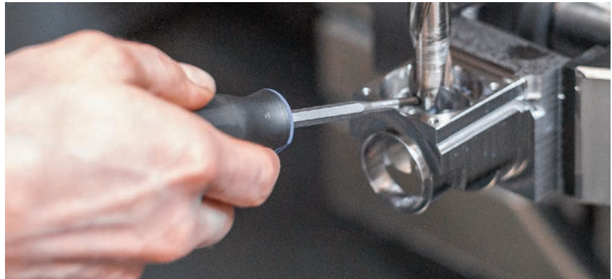
Als Kosten sparender Problemlöser kommt das Schneidplatten Bohrsystem von Arno Werkzeuge zum Zug (Kronenbohrer). Ein Wechsel der Schneideinsätze geht dabei „ratzfatz“.
