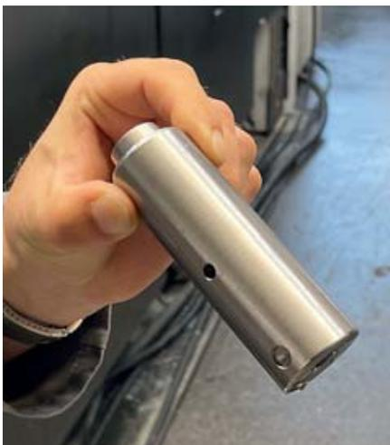
Wichtiges Getriebebauteil für Elektro-Lkw. Sowohl die Präzision der geforderten Teile als auch die Toleranz sind anspruchsvoller als bei vergleichbaren Teilen in der Verbrennertechnik. Bild: Arno
