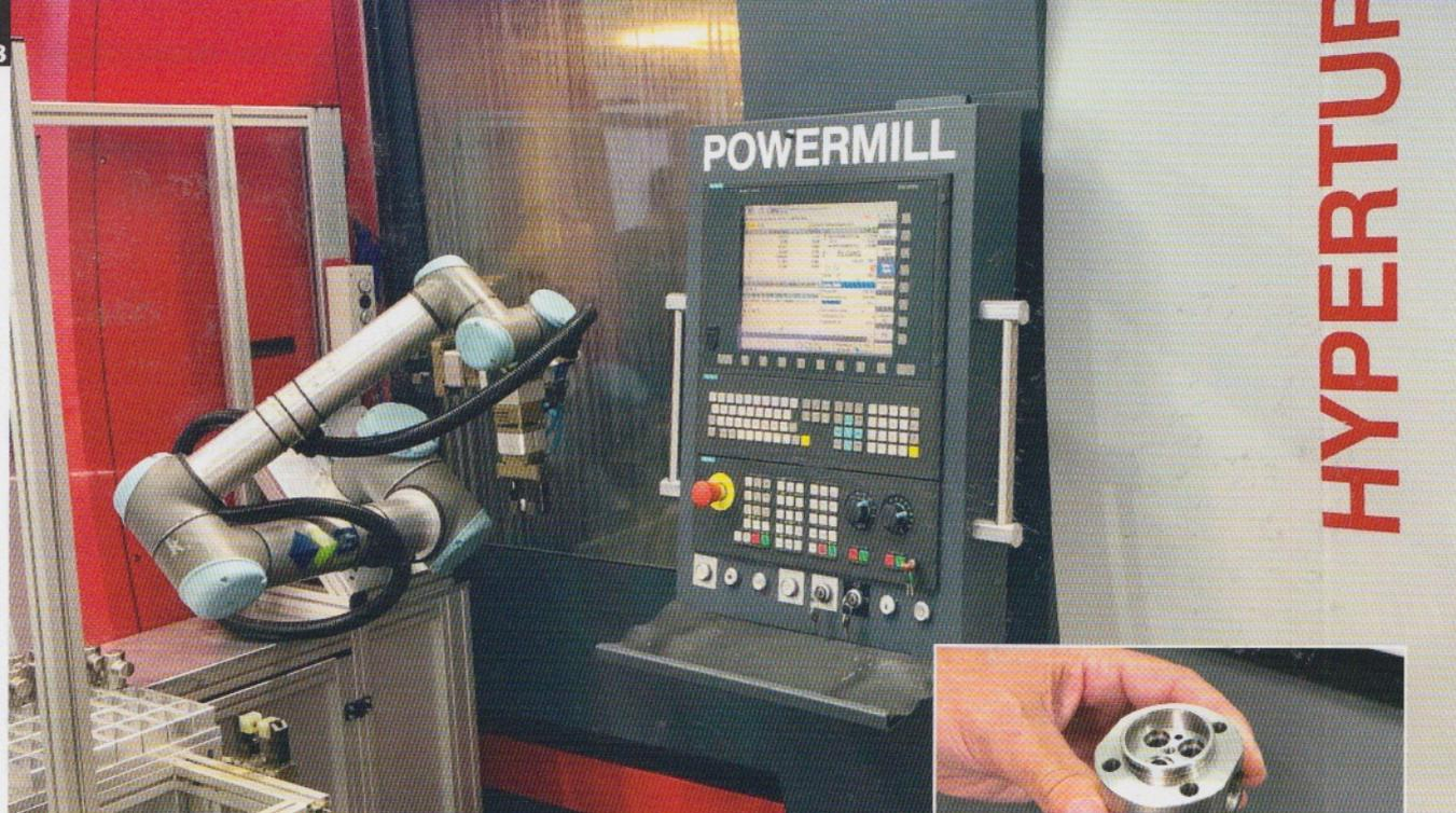
Das Ventilgehäuse wurde früher auf vier Maschinen mit ebenso vielen Aufspannungen bearbeitet. Heute fertigt ein Bearbeitungszentrum mit Haupt- und Gegenspindel das Werkstück in zwei Aufspannungen in einem Bruchteil der früheren Zeit. Und mit Beladeroboter läuft der gesamte Prozess vollautomatisch ab.
