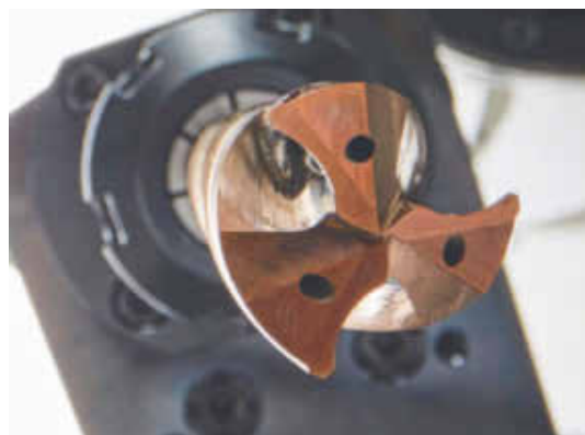
Die Dreifasenföhrung-Innenkühlung des neuen Bohrers sorgt für eine stabile Föhrung in der Bohrung und beim Bohrungsaustritt.
