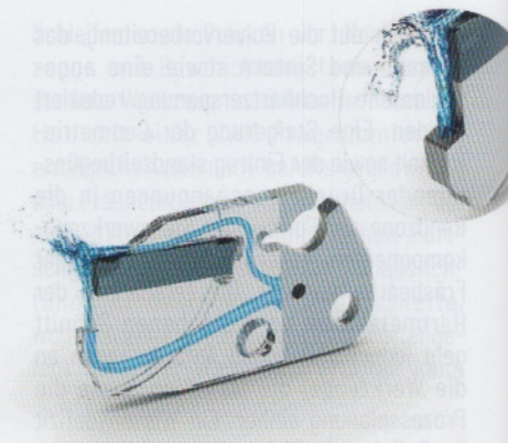
Mit dem additiv hergestellten Stechmodul und dem patentierten ACS (ARNO Cooling System) zur Unterspülung des Spans lassen sich Werkzeugstandzeiten um bis zu 300 % verlängern.
