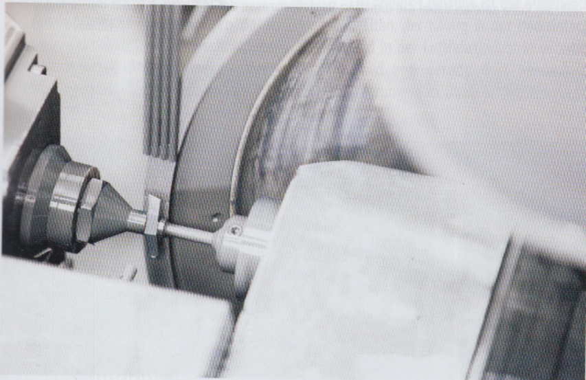
Durch den Einsatz der besonders geschliffenen und polierten Hochpositiven Schneidwerkzeuge reduziert sich der Schnittdruck am Werkstück bei der Bearbeitung.
