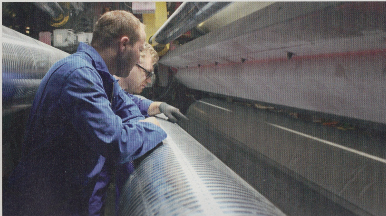
Die Ausrichtung von rotierenden Maschinen ist von immenser Bedeutung. Auf der Maintenance 2019 demonstrieren die Spezialisten den Einsatz der Lasermesstechnik an einem Walzenmodell.
