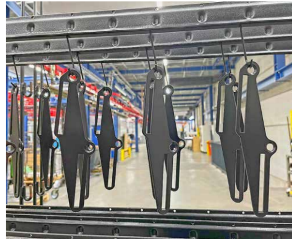
Bemerkenswert ist hier schon die Leistung der KI: Laserteile4you prüft mit einem gemeinsam mit dem Fraunhofer Institut entwickelten KI-Tool, ob ein Teil, das pulverbeschichtet werden soll, auch über eine für dieses Verfahren notwendige Aufhängemöglichkeit verfügt.
