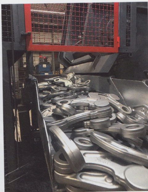
Gestahlte Schmiederohringe in der Austragsrinne der Muldenbandstrahlanlage (Bild: KST Kugel-Strahltechnik).
