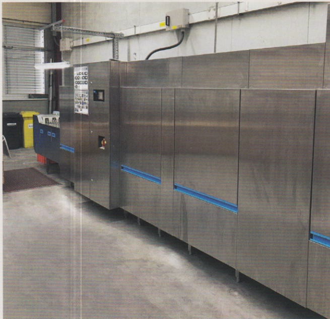
Bild 6: Die 8,70 Meter lange Reinigungs-Bandanlage besteht aus insgesamt fünf Wasch-, Spül- und Trockenzonen. Die Bandnutzbreite misst 570 mm, die Durchfahrthöhe 465 mm. Die Kapazität der Anlage beträgt bis zu 2.200 Teile pro Stunde
