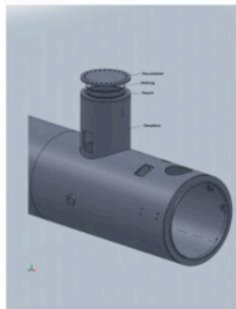
Wichtig bei der Montage der Dichtung bzw. des Flanschendeckels ist das Schmieren der Schraubengewinde. Die Unterseite des Schraubenkopfes/der Unterlegscheibe sollte ebenfalls nicht vergessen werden, um einen möglichst niedrigen Wert für die Haft- und Gleitreibung zu erhalten, damit möglichst wenig von der Einbauschraubenkraft (Drehmoment) verloren geht.
