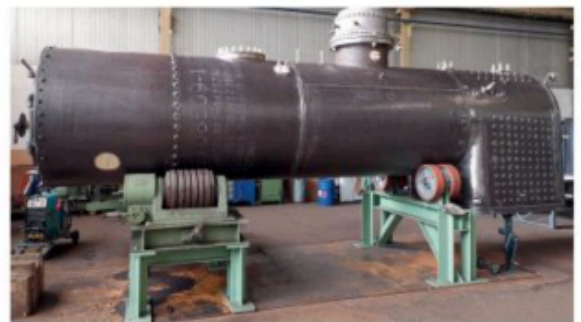
Eine der Stärken von Lonkwitz Edelstahltechnik ist der originalgetreue Nachbau von historischen Dampfkesseln und Zubehör. Bilder: Klinger
