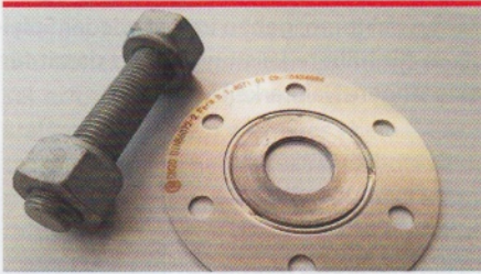
Wellringdichtung mit Druck und Stützring mit extrem niedriger Leckrate und Druck- und Stützring für z.B. Abgasflansche, Schraubenbolzen mit Muttern, Oberfläche Zinklamelle mit Trockenschmierung (Bild: Lannewehr + Thomsen GmbH & Co. KG)
