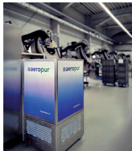
Staubfilter an Fenstern und Aerapur-Luftreiniger sorgen für hochsaubere Produktionsbedingungen ohne Reinraumtechnologie
