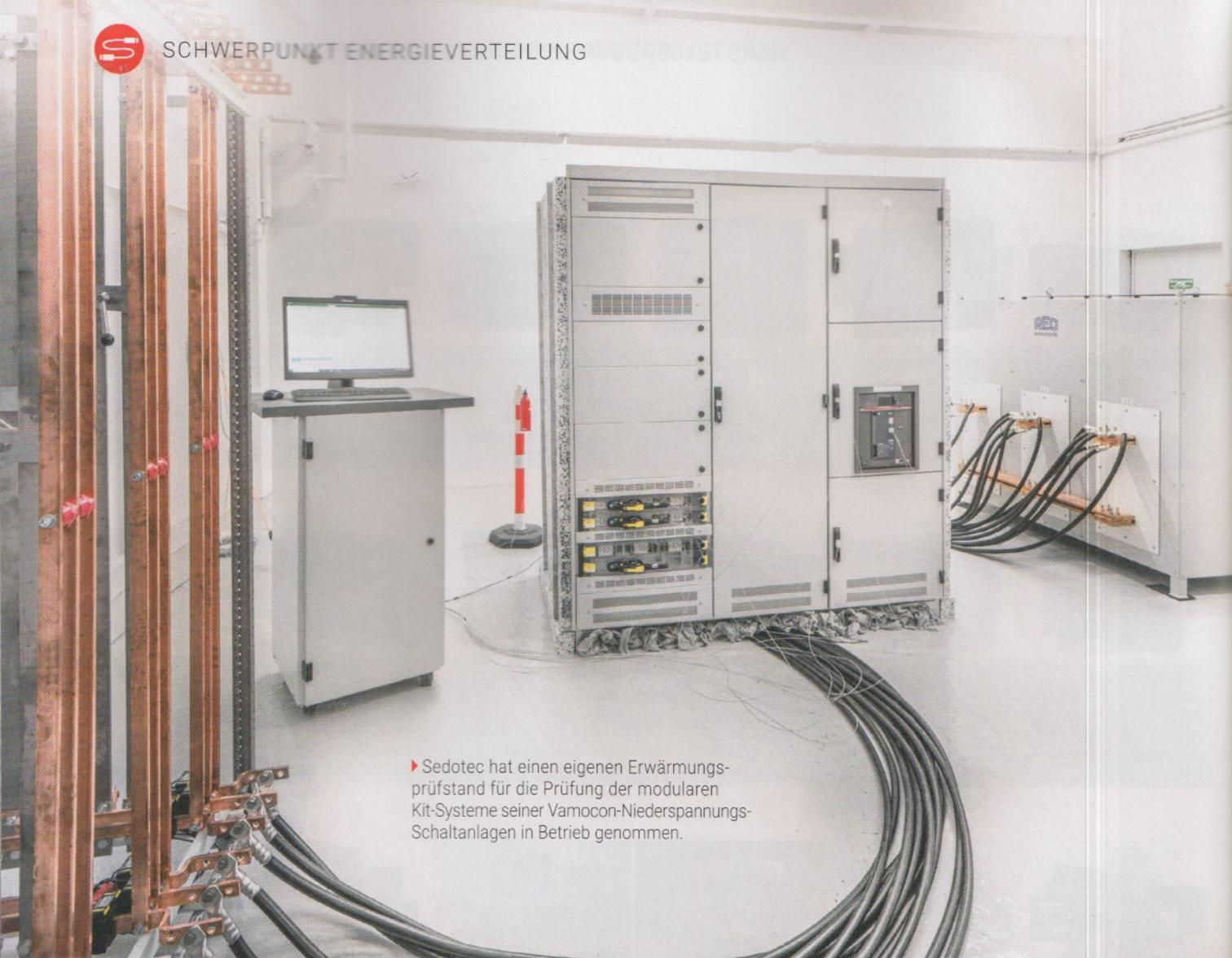
► Sedotec hat einen eigenen Erwärmungsprüfstand für die Prüfung der modularen Kit-Systeme seiner Vamocon-Niederspannungs-Schaltanlagen in Betrieb genommen.
