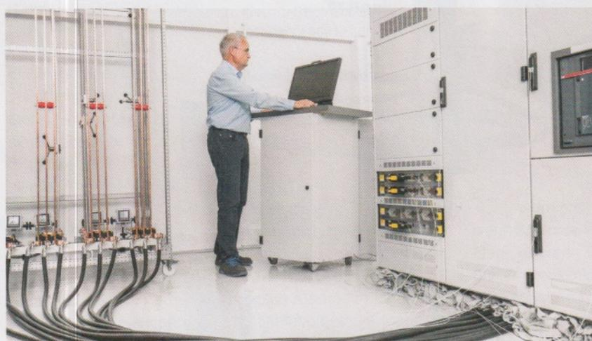
► Moderne Messtechnik bei Sedotec ermöglicht Erwärmungsprüfungen zum Bauartnachweis nach DIN EN61439.
