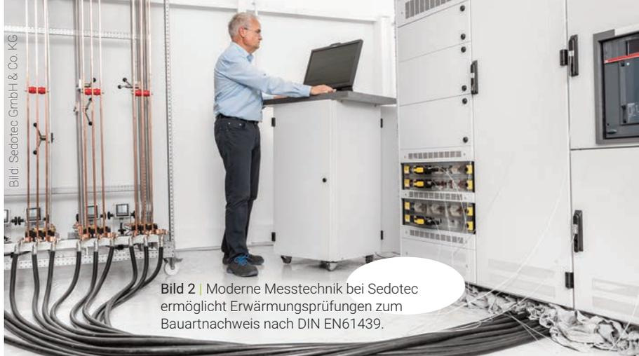
**Bild 2** | Moderne Messtechnik bei Sedotec ermöglicht Erwärmungsprüfungen zum Bauartnachweis nach DIN EN61439.
