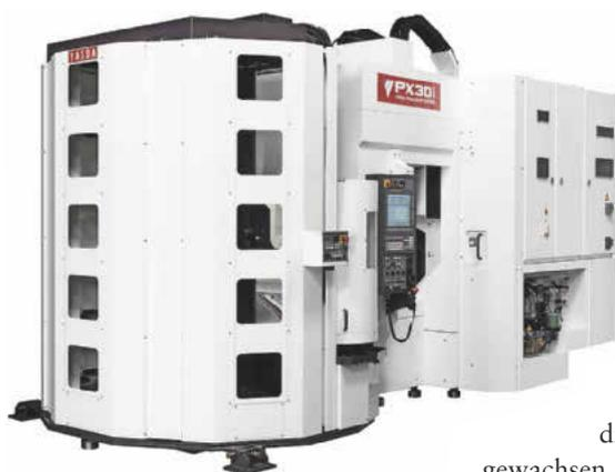
**Bearbeitungszentren** | Yasda rüstet seine High-End 5-Achs-Maschine PX 30i für mittlere und große Serien mit der IHMI-Steuerung aus, basierend auf der Fanuc 31i B5, die auch über ein 15“-Touchdisplay verfügt. Sie bietet 15 M-Codes zum Steuern zusätzlicher Funktionen, weitere
