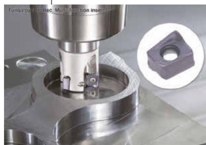
System als Schaft- oder Aufsteckfräser von 25 bis 50 mm oder von 40 bis 160 mm. Die Wiper-Ausführung verspricht zudem hohe Oberflächengüten. ●
