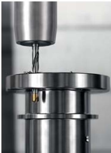
Der neueste Bohrer der CoroDrill-860-Serie von Sandvik Coromant ermöglichte dank fortschrittlicher GM-Geometrie die Bearbeitung eines breiten Spektrums von Werkstoffen und Bauteilen. Außerdem konnte die Werkzeugstandzeit verbessert werden. Der neue Vollhartmetallbohrer basiert auf einer neuen Sorte, einem innovativen Spankanal-Design und einer Bohrer-
